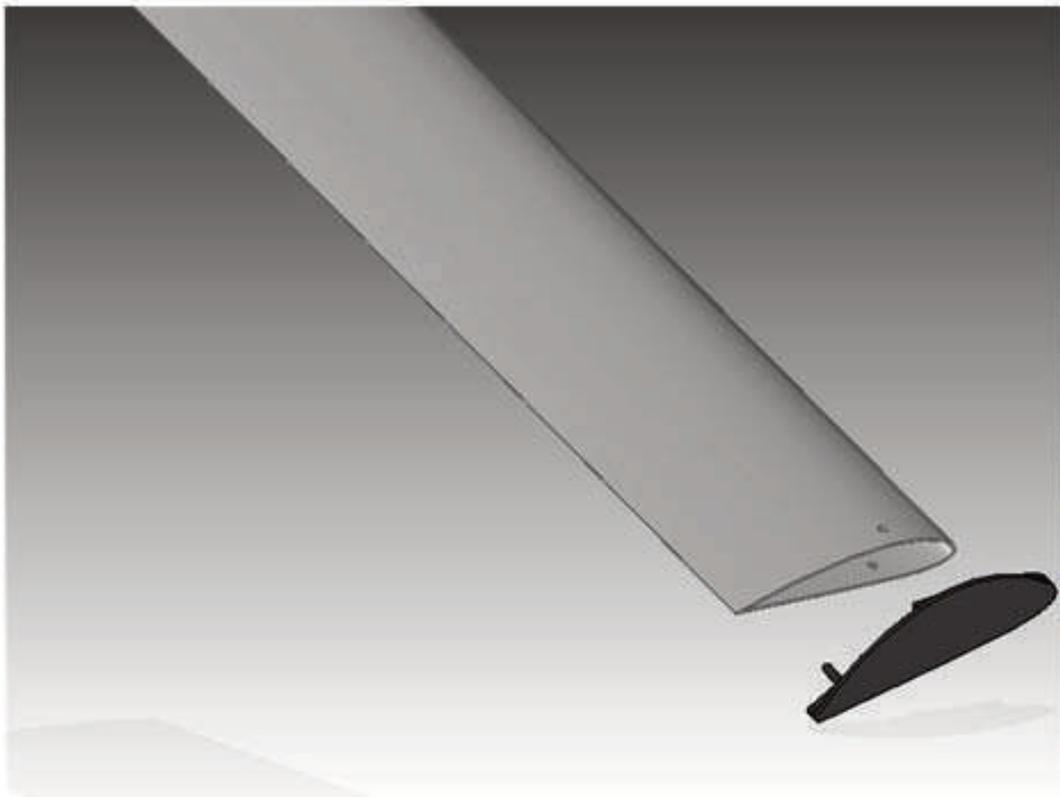
*POSITION THE WINGLET AT BLADE TIP
